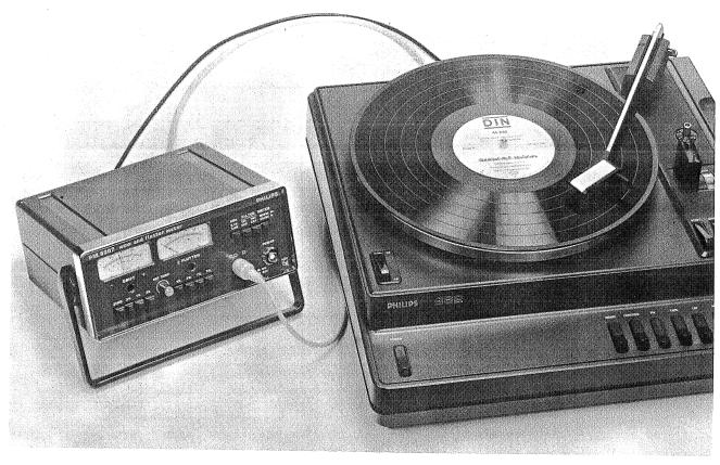
Fig. 5 Wow and flutter measurements of a record player Gleichlaufmessung an einem Plattenspieler Mesure de wow et flutter d'un tourne-disques
