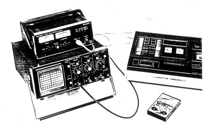
Fig. 6 Wow and flutter measurements of a cassette recorder Gleichlaufmessung an einem Cassetten-Recorder Mesure de wow et flutter d'un enregistreur sur cassettes
