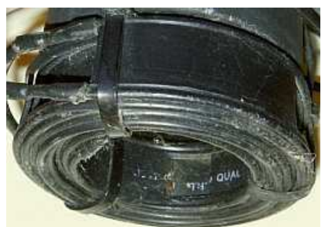
Een opgerolde "slotted" ± 450 Ohm lintlijn.
