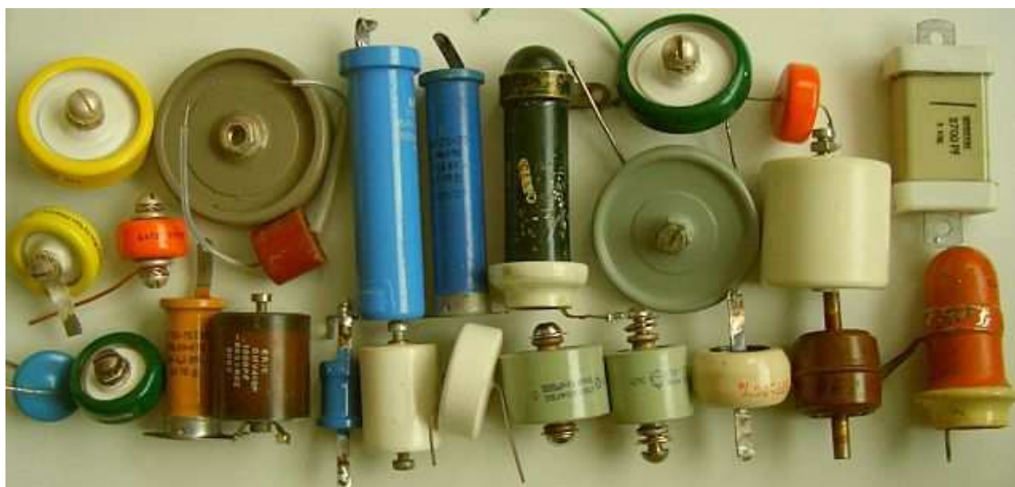
Voorbeelden van een type condensator dat geschikt is voor de verkorting.
